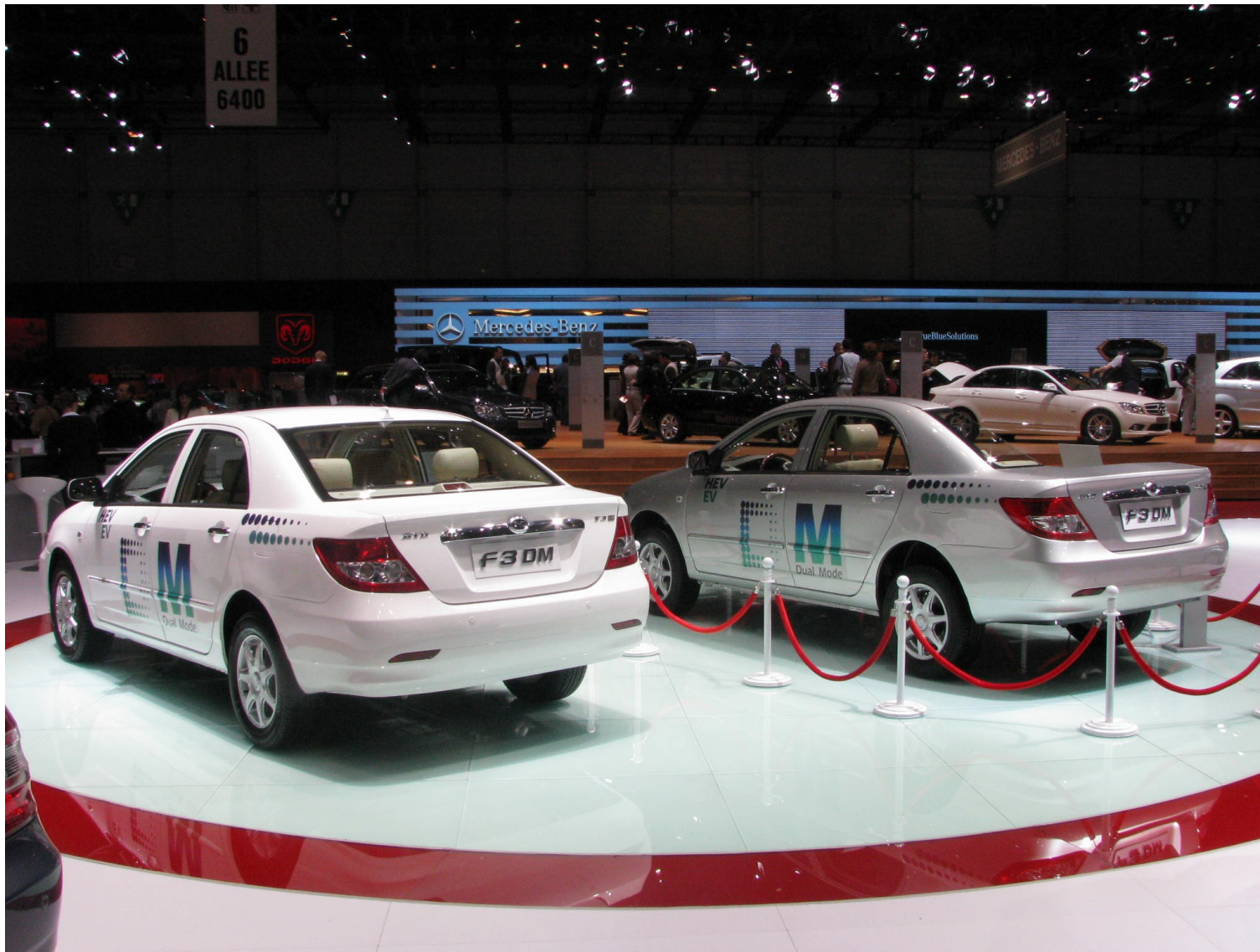
2008 Genfer Autosalon: Wenn im Osten die Sonne aufgeht verblassen die Sterne BYD Plug-in Hybrid. 20 kWh Lithium Eisen Phosphat 110km rein elektrisch 230V und 60 kW Schnellladeanschluß
